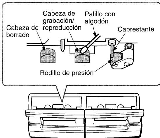
Después de limpiar las cabezas y los puntos por donde pasa la cinta con un cassette de limpieza de cabezas que emplee líquido o un palillo con algodón humedecido en líquido de limpieza, espere hasta que las partes limpiadas estén completamente secas antes de introducir las cintas.
